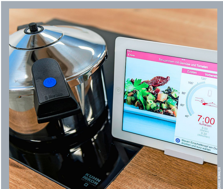
Digitale Dampfkochtopf: Ein Temperatursensor im Deckel übermittle die Temperatur des Gargutes sowie Bedienfehler an eine App.
